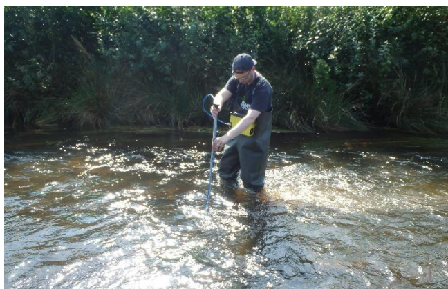
Figur 5: Opmåling af fysiske forhold, her vandhastigheder.
