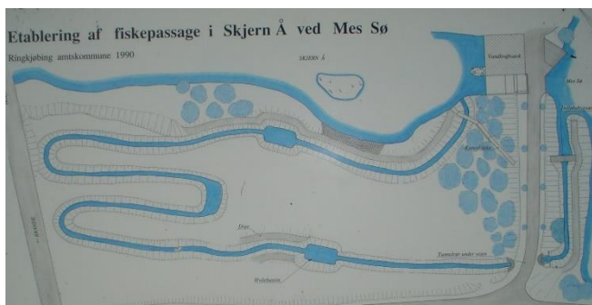
Figur 3: Vandkraftværket MES (t.h.) og skitsering af fiskepassagen mellem MES Sø og Skjern Å.
