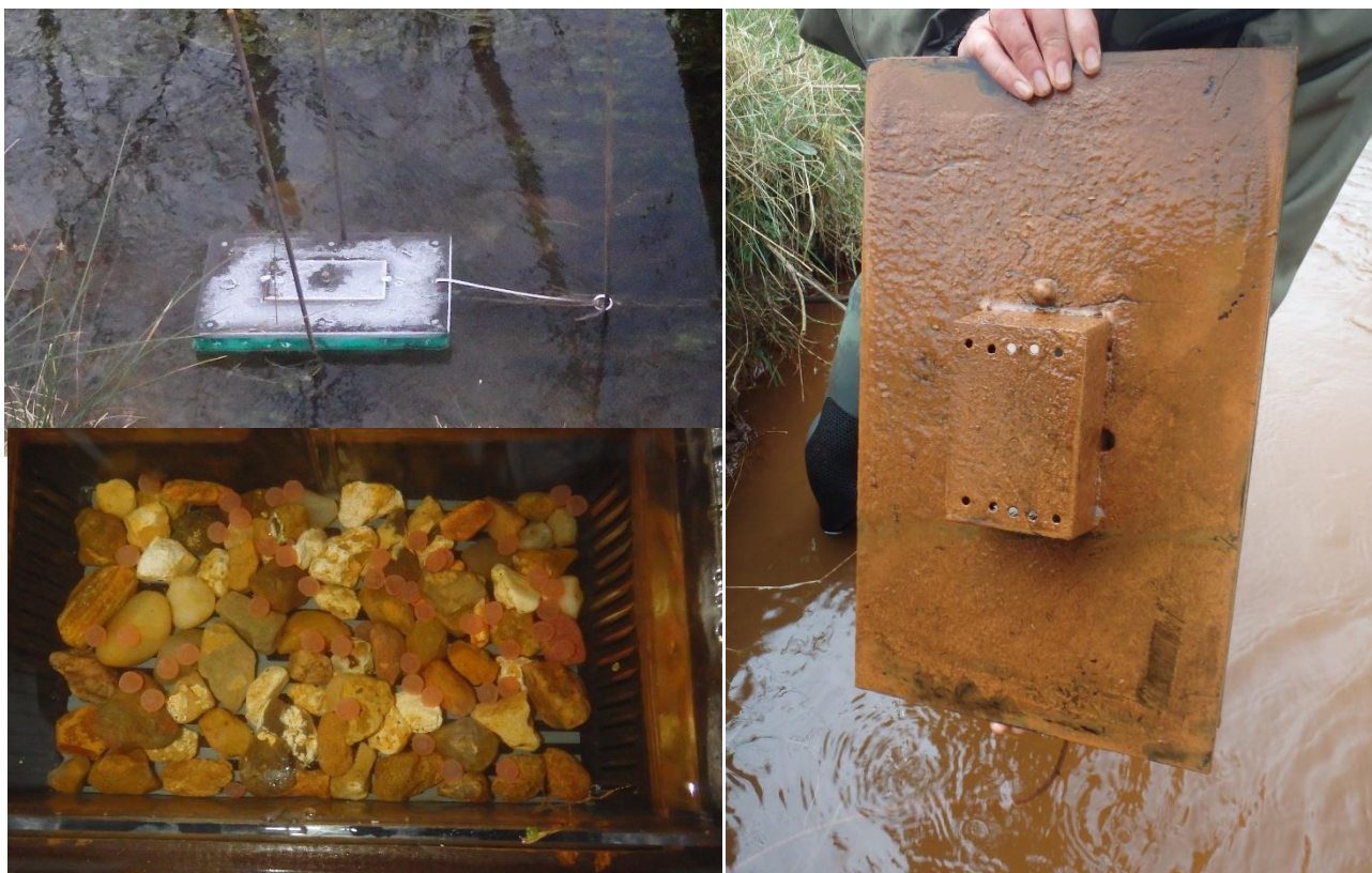
Figur 5: Rugekassen. Øverst: Rugekasse i vandløb. Nederst: Nybefrugtede lakseæg i ægbeholderen med grus i bunden. Vandgennemstrømning via riller i opstrøms og nedstrøms ende af ægbeholderen. Klækkede blommesækkyngel (og fint, udfældet materiale) forlod ægkammeret via bredere riller i bunden af kassen. T.h.: Undersiden af rugekassen med huller hvor udfældet materiale skylles ud.
